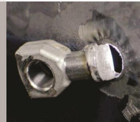
**Доказанная прочность** Ударные испытания: Сварные швы не расходятся даже тогда, когда разрушается стена
